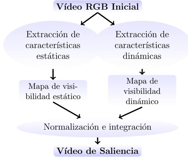
Figura 1.9: Esquema del modelo de Nabil Ouerhani. Este esquema realiza por una parte la extracción estática de características y por otra la extracción dinámica.
