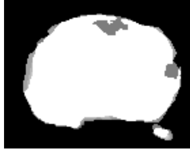
Figura 3.47: Mapa de regiones de entrada al sistema de integración extraída de las imágenes de la figura 3.43. El sistema decidirá sobre el etiquetado de las regiones con nivel de gris mayor que 0 y menor que 255.
